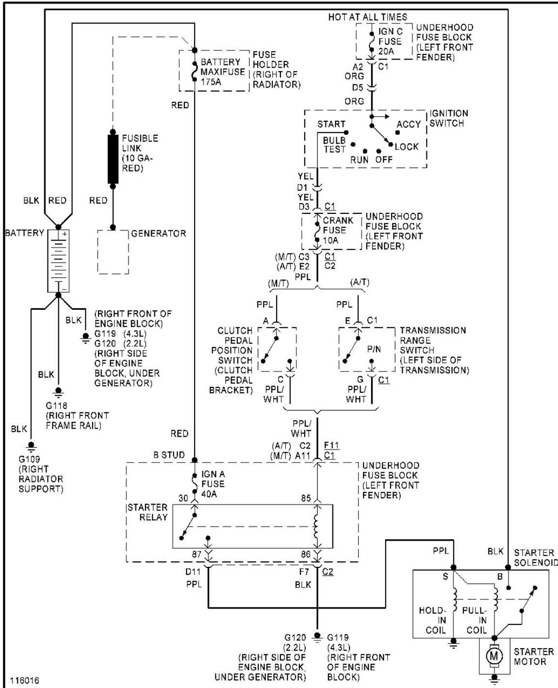
**Fig. 49: Starting Circuit**
